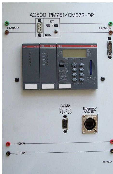
In die Experimentierplatte „**ABB AC500 CPU PM751 CM572-DP**“ ist als CPU eine PM751 als PROFINET Master eine CM572-Baugruppe und das Koppler-Leergehäuse TA524I eingebaut
