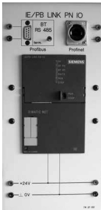
Der in die Experimentierplatte „**IE/PB LINK**“ eingebaute Netzübergang zwischen PROFINET und PROFIBUS ermöglicht die Anbindung von Profibus DP –Slaves an einen PROFINET IO-Controller über Echtzeitkommunikation (RT) gemäß PROFINET-Standard. Aus Sicht des IO-Controllers werden alle DP Slaves behandelt wie IO-Devices mit Ethernet-Schnittstelle, d.h. das IE/PB Link PN IO ist deren Stellvertreter (Proxy). Aus Sicht der DP-Slaves ist das IE/PB Link der DP Master.
