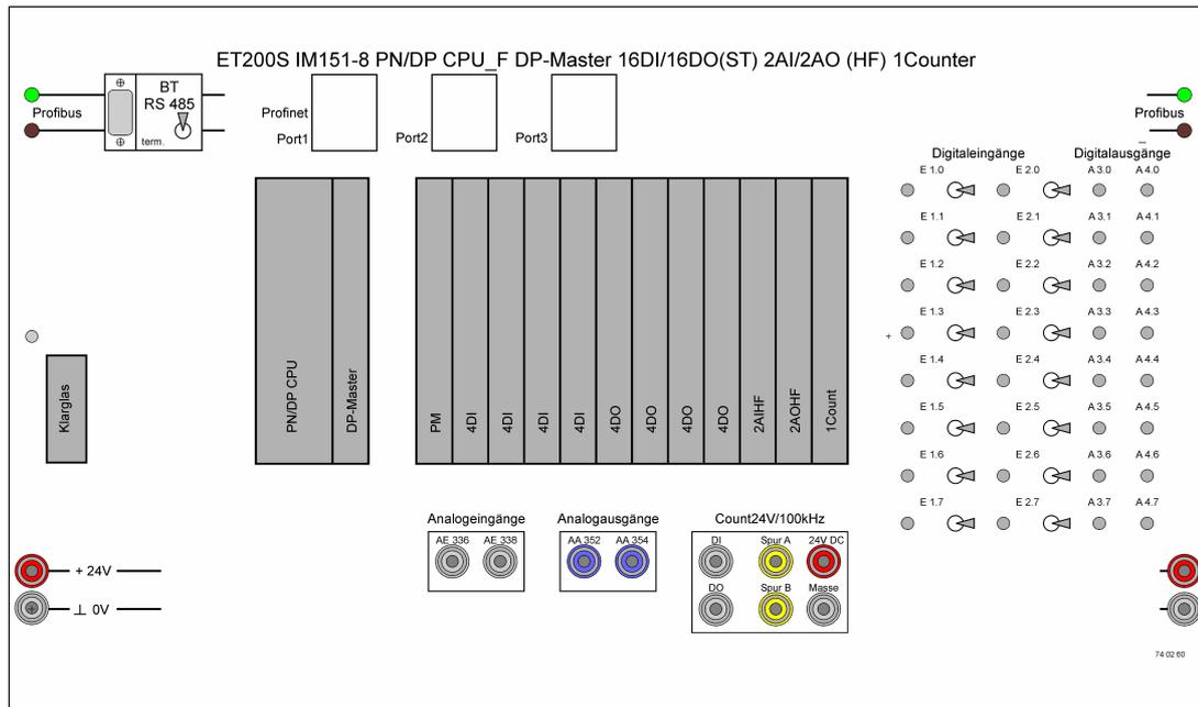
In die Experimentierplatte „**S7-300 ET200S IM151-8 PN/DP CPU / DP-Master 16DI / 16 DO (ST) 2AI / 2AO (HF) 1Count**“ ist als CPU eine ET200S IM151\_8F eingebaut. Das Interfacemodul IM151-8 PN/DP CPU kann neben der Steuerungsfunktionen zudem
