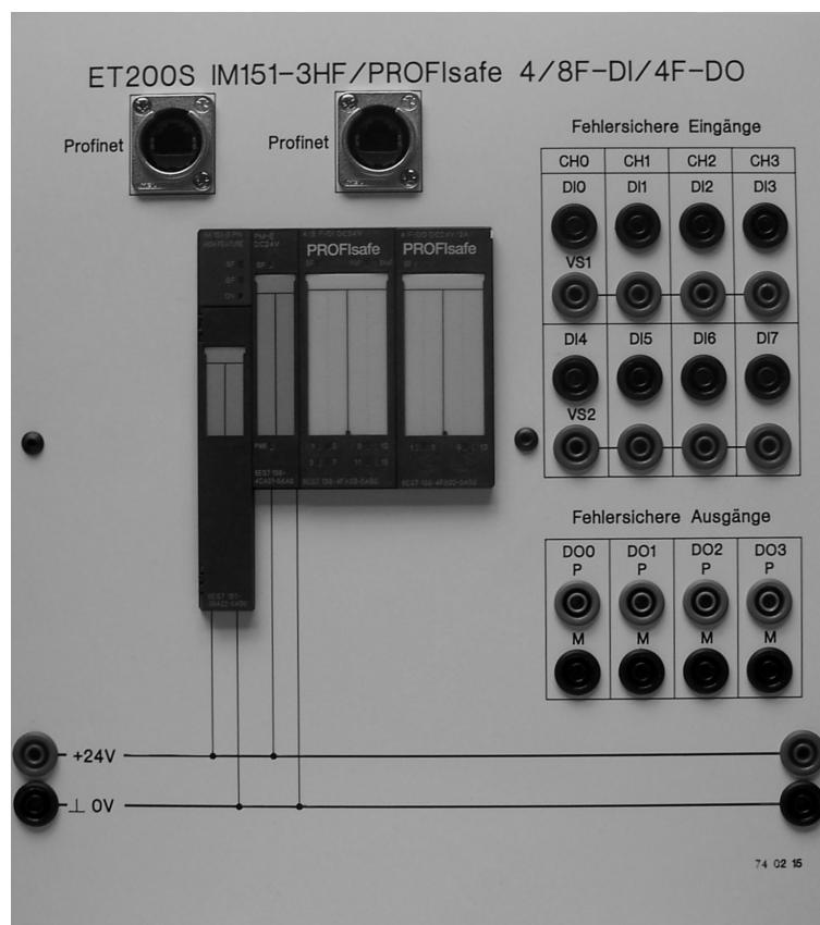
In die Experimentierplatte „**ET200S PROFISAFE**“ ist das Interfacemodul IM 151-3HF eingebaut, welches die Anbindung der ET200S an PROFINET ermöglicht und die Kommunikation zwischen den ET200S-Modulen und dem übergeordneten PROFINET I/O-Controller selbstständig abwickelt. Ferner ist ein Power-Modul, ein F-Digitaleingabemodul 4/8 F-DI und ein F-Digitalausgabemodul 4F-DO eingebaut.
