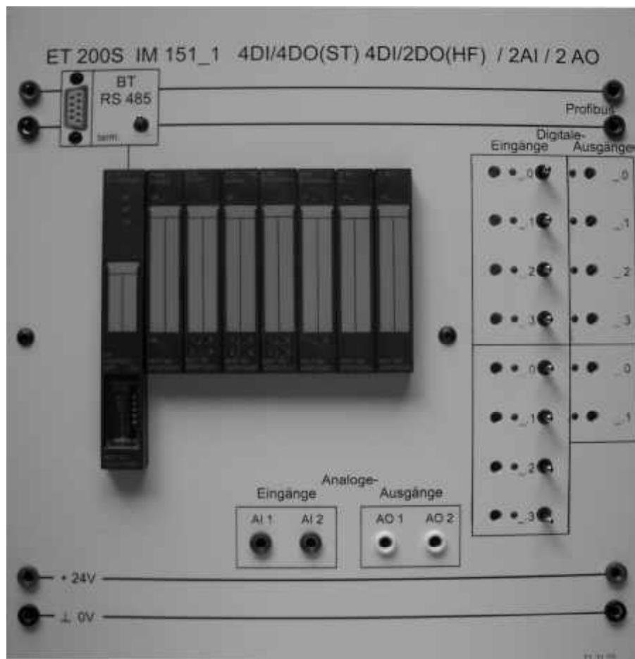
In die Experimentierplatte „**S7-300 ET200S IM151-1 / 4 DI/DO(ST) 4DI/2DO(HF) 2 AI/AO**“ ist eine ET200S IM151-1 eingebaut. Die Anschaltbaugruppe IM 151 wird als Slave-Teilnehmer in ein PROFIBUS-Netz integriert.
