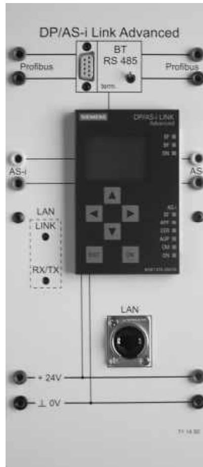
In die Simulationsplatte DP/AS-Interface-Link ist das DP/AS-Interface Link Advanced eingebaut, welches gleichzeitig PROFIBUS-DP Slave und AS-Interface Master ist. Das DP/AS-INTERFACE LINK Advanced verbindet das Aktor-Sensor-Interface mit PROFIBUS DP. Mit Hilfe von DP/AS-INTERFACE LINK Advanced können vom PROFIBUS DP auf die Ein- und Ausgänge der AS-i Slaves zugegriffen werden. Folgende AS-i Slaves können verwendet werden:
