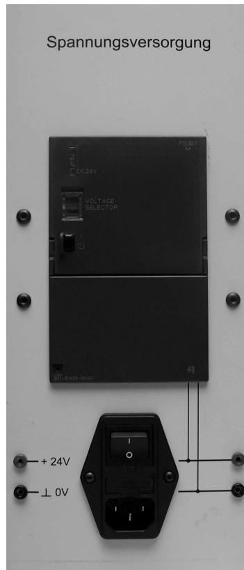
Die Experimentierplatte „Spannungsversorgung“ ist für die Versorgung der S7-Experimentierplatten und eventuell angeschlossenen Technologiesimulatoren oder Prozessperipherie mit einer geregelten Gleichspannung von 24V erforderlich. In die Platte ist die SIEMENS Laststromversorgungsbaugruppe PS 307-5A eingebaut. Die Spannungsversorgung ist universell für alle Experimentierplatten einsetzbar.
