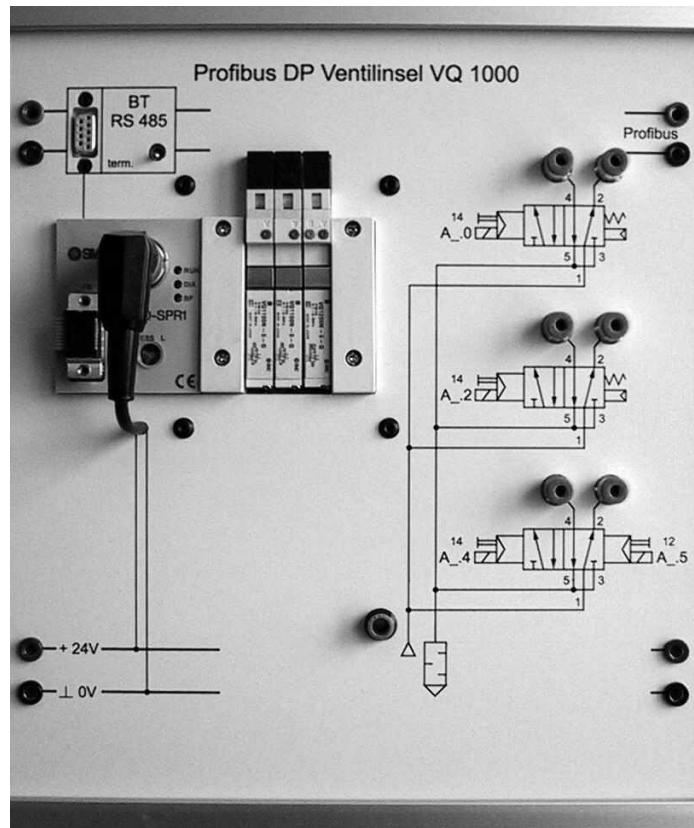
Auf die Experimentierplatte „Profibus DP Ventilinsel VQ1000“ ist eine Ventilinsel der Firma SMC montiert. Die Ansteuerung der Ventilinsel erfolgt über den Profibus DP. Die Ventilinsel ist mit zwei 5/2-Wege Ventilen mit Rückstellfeder und mit einem 5/2-Wege Impulsventil bestückt. Die Anschlüsse der Ventile sind über selbstabsperrende 4mm Schnellverschlusskupplungen auf die Frontplatte geführt. Die zentrale Luftzuführung für die Ventile erfolgt über eine 6 mm Schnellverschlusskupplung.
