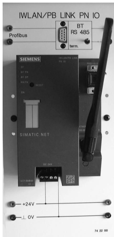
Der in die Experimentierplatte „**IWLAN/PB LINK PN IO**“ eingebaute Netzübergang zwischen Industrial Wireless LAN und Profibus ermöglicht die Anbindung von Profibus DP – Slaves an einen PROFINET IO-Controller. Aus Sicht des IO-Controllers werden alle DP Slaves behandelt wie IO-Devices mit Ethernetschnittstelle, d.h. das IWLAN/PB Link PN IO ist deren Stellvertreter (Proxy). Aus Sicht der DP-Slaves ist das IWLAN/PB Link PN IO der DP Master.
