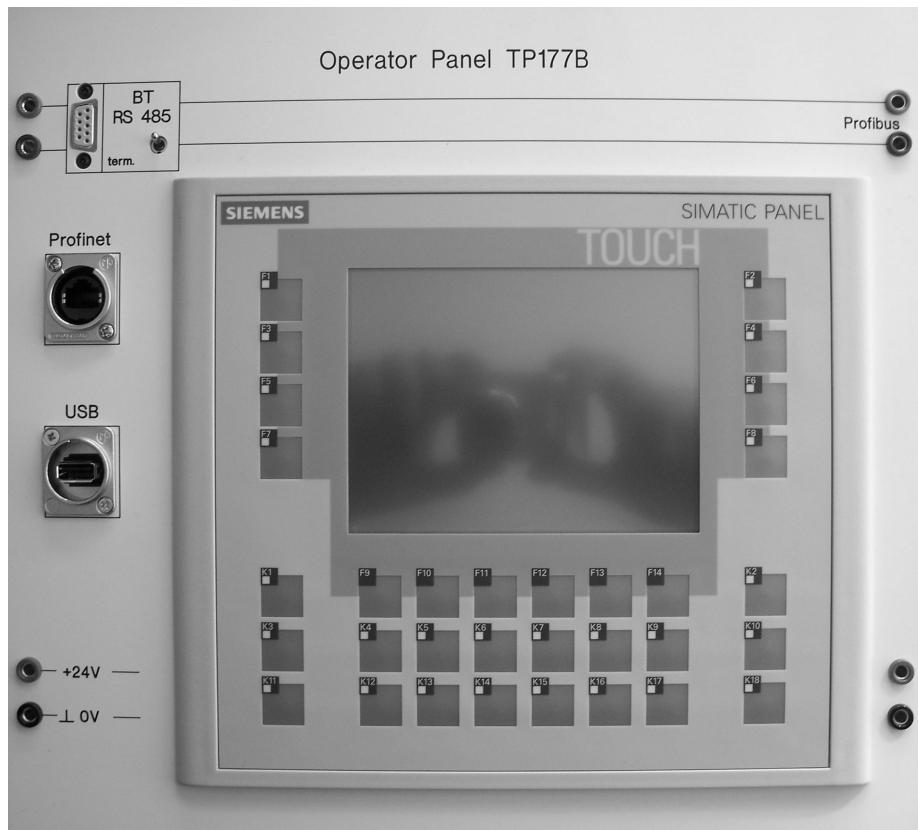
In die Simulationsplatte ist das Operator-Panel TP177B color der Firma SIEMENS eingebaut. Die 177er-Panels stellen einen Weiterentwicklung der 170er-Reihe dar und werden mit WinCC-flexible projektiert. Das TP 177B verfügt über Schnittstellen für den Anschluss an PROFIBUS und PROFINET sowie über eine USB-Schnittstelle. Alle Schnittstellen sind auf fronseitig zugängliche Stecker geführt.
