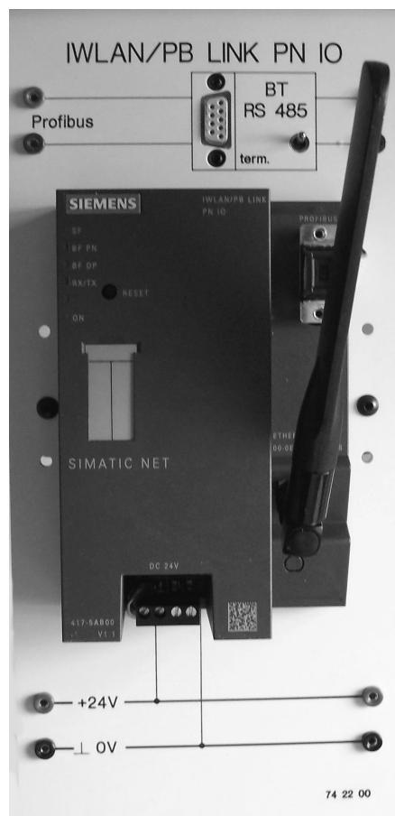
Der in die Experimentierplatte „**IWLAN/PB LINK PN IO**“ eingebaute Netzübergang zwischen Industrial Wireless LAN und Profibus ermöglicht die Anbindung von Profibus DP – Slaves an einen PROFINET IO-Controller. Aus Sicht des IO-Controllers werden alle DP Slaves behandelt wie IO-Devices mit Ethernetschnittstelle, d.h. das IWLAN/PB Link PN IO ist deren Stellvertreter (Proxy). Aus Sicht der DP-Slaves ist das IWLAN/PB Link PN IO der DP Master.
